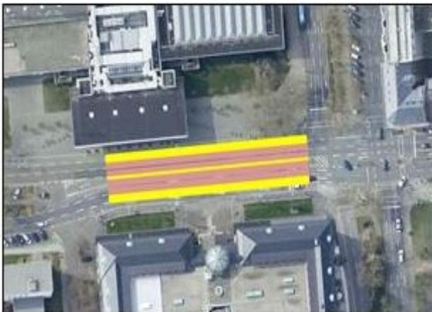
4 Fahrspuren à 3,25 m, minimaler Mittelstreifen ca. 1,50 m, mittlerer Flächengewinn beidseits
