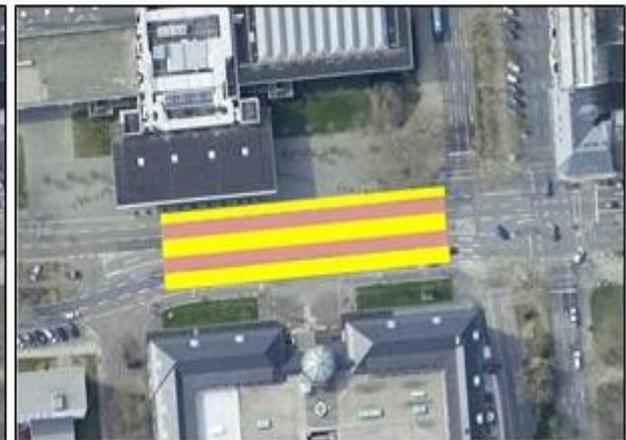
2 überbreite Fahrspuren à 4,50 m (Modell Biebricher Allee), breiter Mittelstreifen ca. 5,50 m, Flächengewinn beidseits
