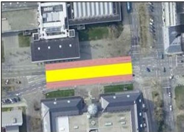
4 Fahrspuren à 3,25 m, überbreiter Mittelstreifen ca. 9 m, beidseits kein Flächengewinn
